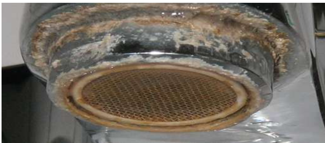
Figura 3 – Imagem de um aerador de torneira de uma unidade que presta assistência à saúde. Fonte: Water hygiene and safety - A practical approach to ensuring safe water , 2012
