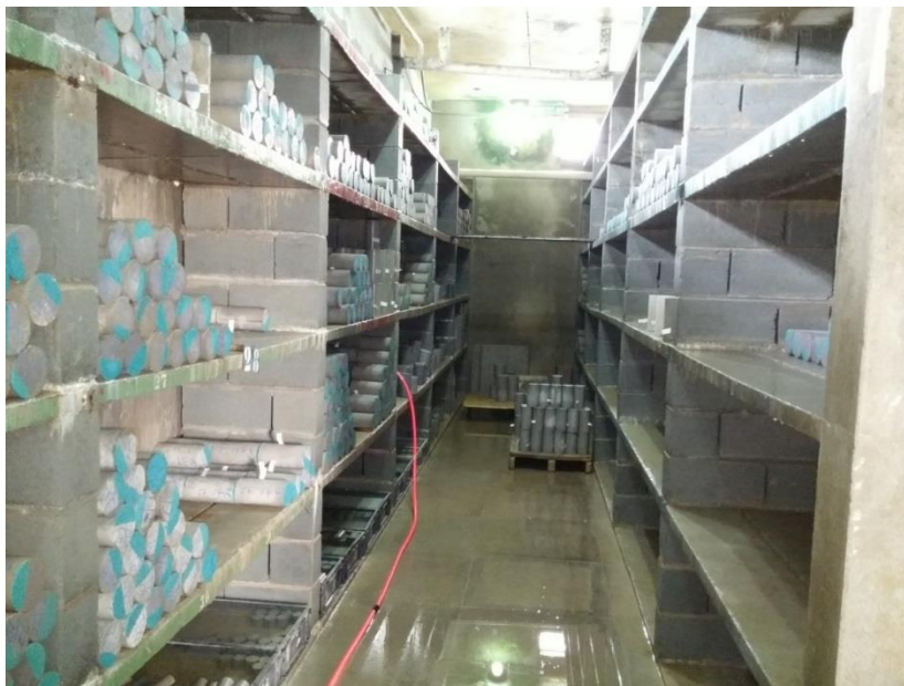
Figura 19 - Vista interna da câmara úmida
