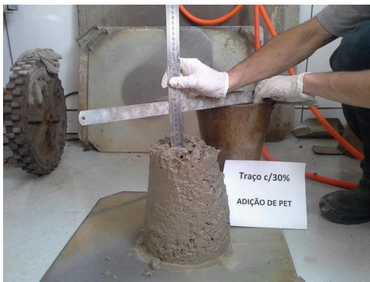
Figura 16 – Ensaio de determinação da consistência do concreto
