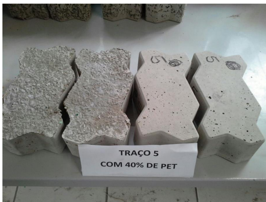
Figura 21 - Blocos em estado endurecido já desenformados
