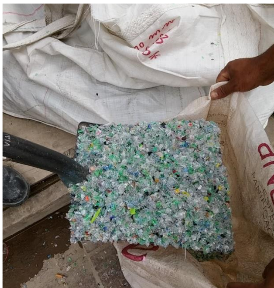
Figura 10 - Amostra do resíduo de PET utilizado nos ensaios
