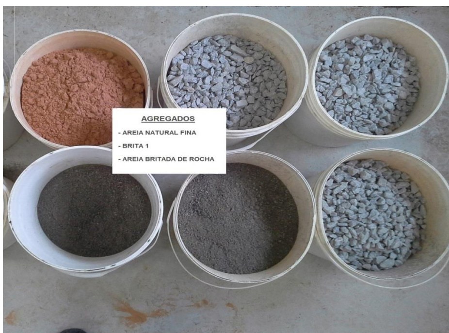
Figura 13 - Amostra dos agregados utilizados nos ensaios: a areia rosa natural de rio, a brita 1 de pedreira e a areia de rocha (britada)
