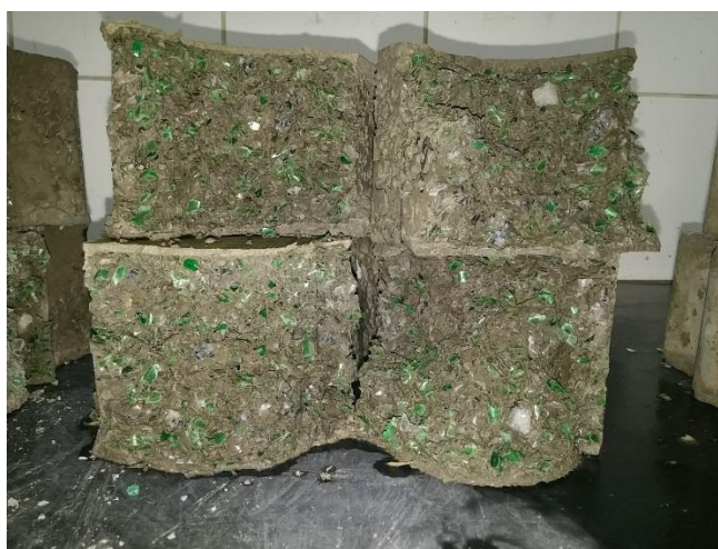
Figura 31 – Bloco de concreto com resíduo de PET.
