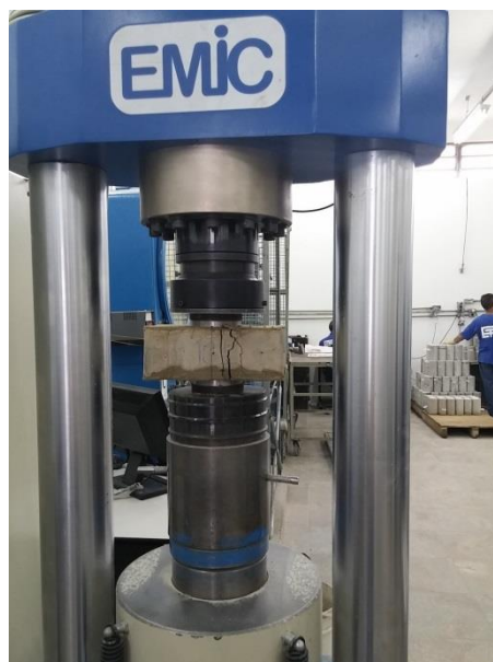
Figura 30 – Ensaio de resistência à compressão em andamento
