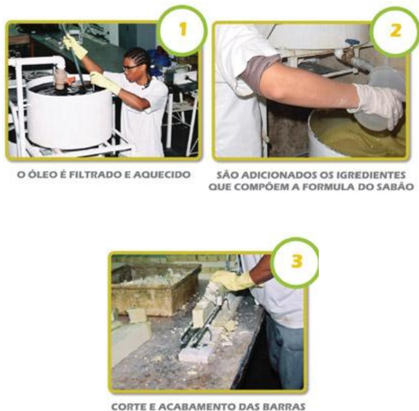
**FIGURA 3** – Processo de fabricação de sabão a partir de óleo residual
