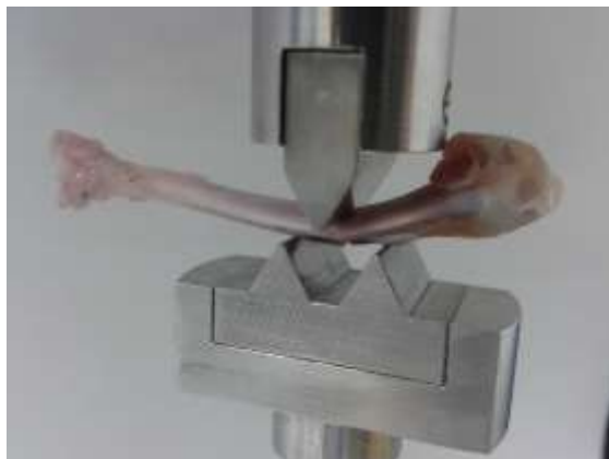
Figura 6: Posicionamento do osso tibial para ensaio mecânico.
