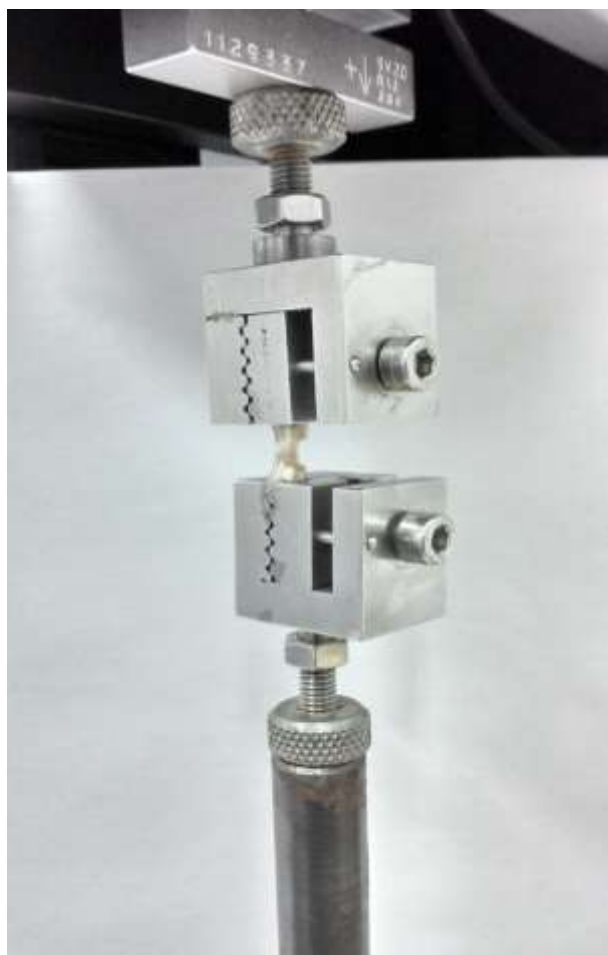
Figura 5: Foto do tecido acoplado ao aparelho de ensaio mecânico (EMIC2000).
