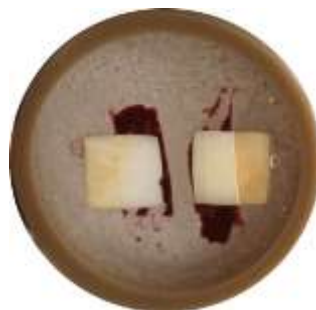
Figura 8: Cada tubo de PVC contém duas amostras, e cada amostra possui duas regiões: metade sadia (protegido antes de ser submetido ao ataque ácido) e a outra metade lesionada (submetido ao ataque erosivo).
