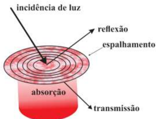
Figura 4: A incidência de luz coerente sobre uma superfície pode provocar quatro fenômenos físicos: absorção, reflexão, espalhamento e transmissão.
