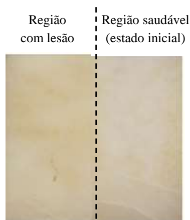
Figura 9: Nas amostras, a região lesionada está disposta à esquerda (submetido ao ataque ácido), e a região saudável está disposta à direita (protegido durante o ataque ácido).
