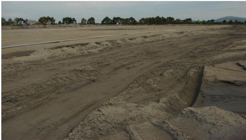
Figura 24 – Cinzas pesadas na lagoa depois de sedimentadas
