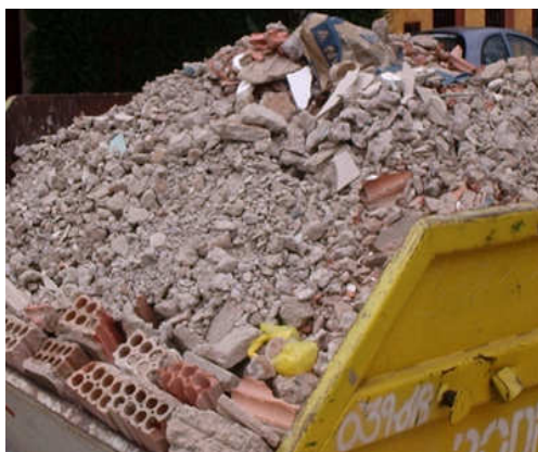
A) Resíduo da construção civil bruto
