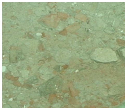
B) Resíduo da construção civil triturado
