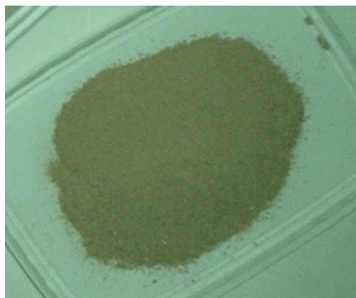
C) Resíduo da construção civil peneirado
