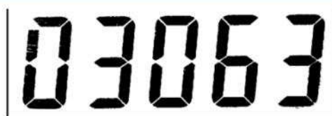
(b) RI após limiarização e remoção dos componentes conexos pequenos
