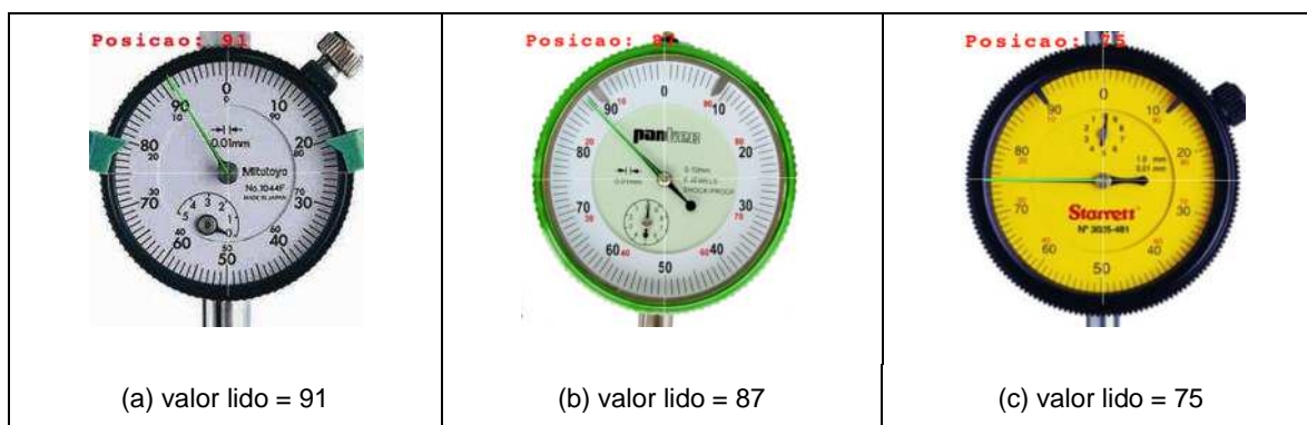
Figura 53 – Resultado do algoritmo de detecção de ponteiro.
