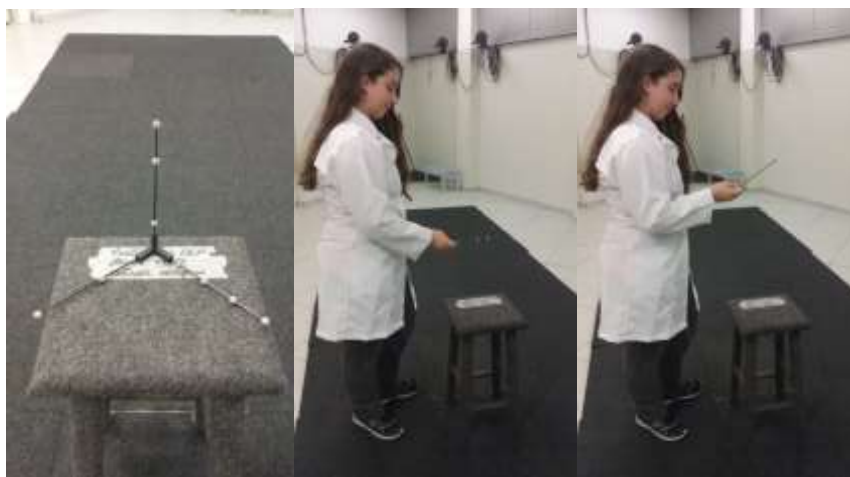
Figura 5: Calibração prévia do aparelho, conforme coordenadas tridimensionais
