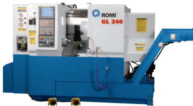
Figura 41 – Torno CNC de precisão marca Romi modelo GL240 utilizado para usinagem do material endurecido.
