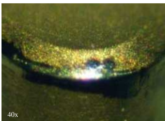
Figura 78 - Desgastes da ferramenta COM Lubrificação para V_c = 96 m/min, f = 0,01 mm/v e a_p = 0,05 mm.
