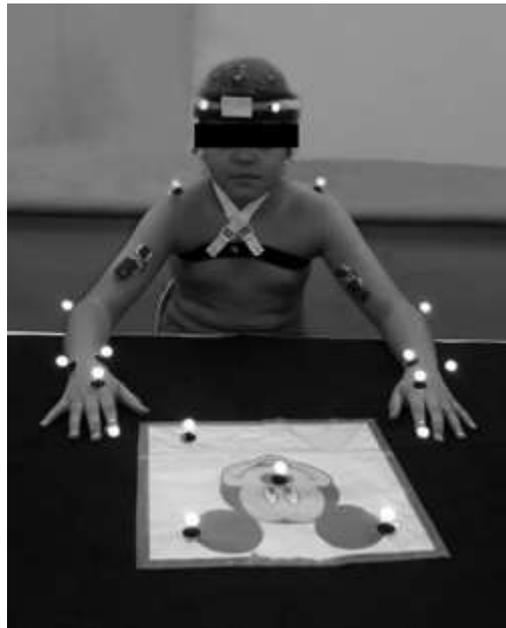
**Figura 10.** Arquivo pessoal: Colocação de marcadores para análise tridimensional usando SMARTup: a configuração experimental.<sup>67</sup>
