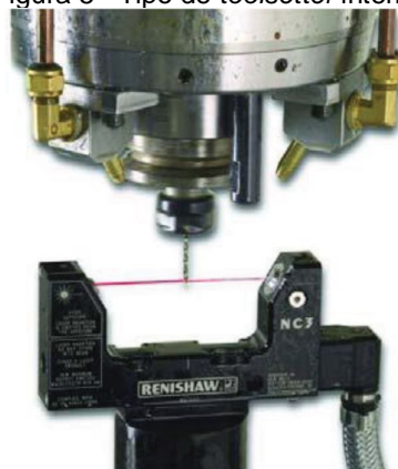
Figura 5 - Tipo de toolsetter interno
