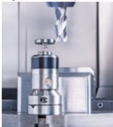
Figura 6 - Toolsetter por contato
