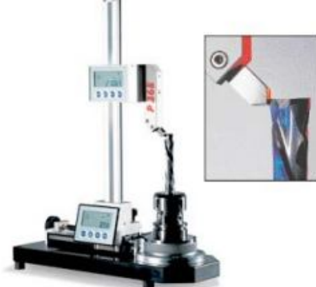
Figura 4 - Tipo de presetter por contato
