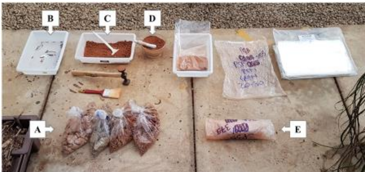
Figura 3.3 – Destorroamento das amostras. A – Amostras secas. B – Retirada de pedras, raízes e demais materiais. C – Pré destorroamento com martelo. D – Moagem mais fina com almofariz. E – Material colocado em saco devidamente identificado.
