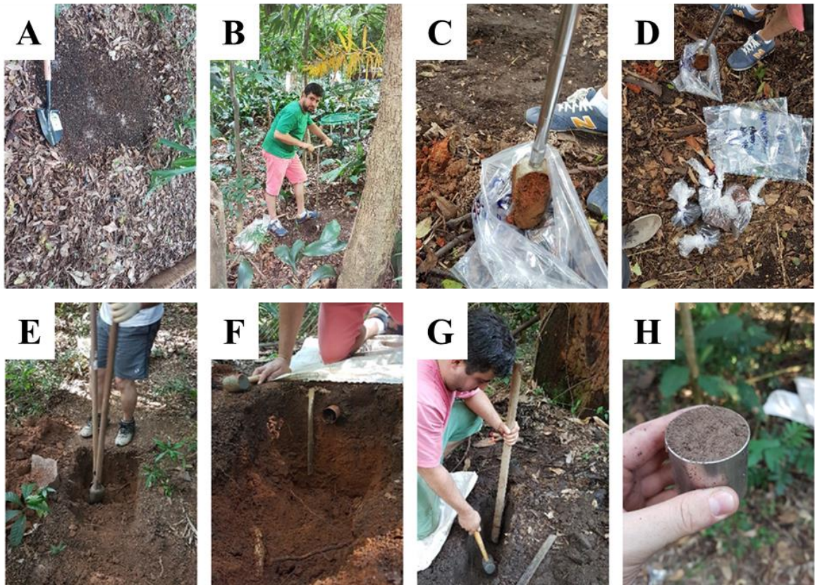
Figura 3.2 - Processo de coleta de amostras de solo para ensaios de granulometria e espectrometria. A - Remoção de serapilheira. B – Utilização do Trado Holandês. C – Retirada da amostra do solo e colocação em saco plástico identificado. D – Espaço de coleta. E – Abertura de trincheira, com o uso de cavadeira. F – Quando atingida a profundidade prevista para a coleta, confirmada com o uso de régua, é posicionado o cilindro metálico em parede de solo previamente alinhada. G – Cravação de cilindro, sem causar compactação do solo interno, para ensaio de densidade. H – Amostra nivelada no cilindro metálico. Fonte: Acervo pessoal (2018).
