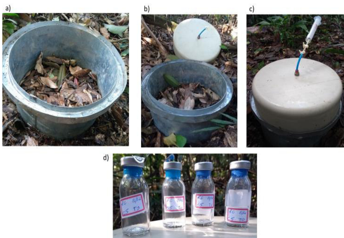
Figura 3. Câmara estática e componentes para a coleta de gases. Na figura 5A, a câmara estática de alumínio, em 5B câmara estática de alumínio com tampa de acrílico e adaptador para captar o gás concentrado, em 5C câmara estática de alumínio vedada com água na borda, fechada com tampa de acrílico e com uma seringa de 20 ml 5D frascos de vidro de 20 ml para aprisionar os gases coletados.
