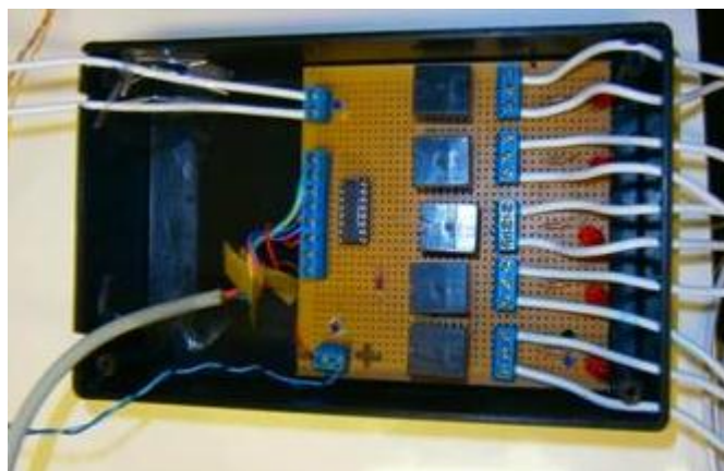
Figura 18 - Circuito eletrônico para controle das lâmpadas fixados na caixa de proteção
