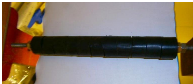
Figura 26 - Roletes que apóiam a cinta de transporte na base da esteira.
