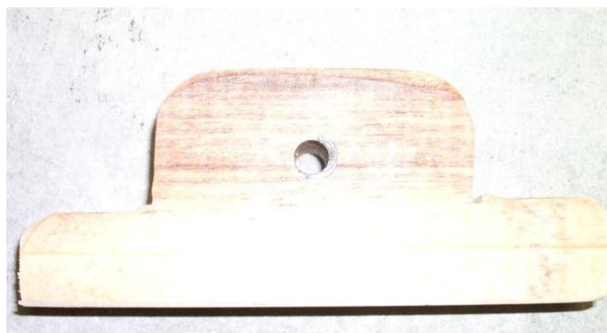
Figura 24 - Mancal confeccionado para fixação dos eixos.
