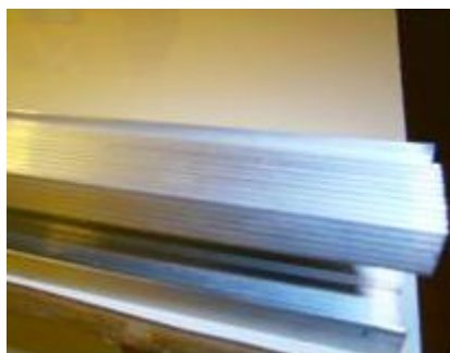
Figura 10 - Trilho de cortina para apoio da placa de MDF e da placa de lona (cinta da esteira).
