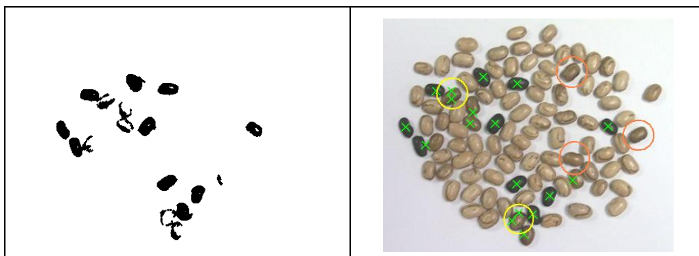
Figura 37 - Resultados do algoritmo contendo casos falsos positivos e falsos negativos. (a) Componentes conexos filtrados. (b) Falsos positivos causados por efeitos de sombra (círculos azuis), estrias escuras (círculos vermelhos) e efeitos de sombra + estrias escuras (círculo preto). (c) Componentes conexos filtrados (d) Falsos positivos (círculos amarelos) e falsos negativos (círculos laranja).
