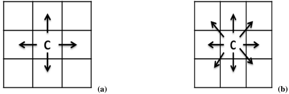
Figura 05 - Vizinhança de pixels. (a) conectividade-de-4, (a) conectividade-de-8.
