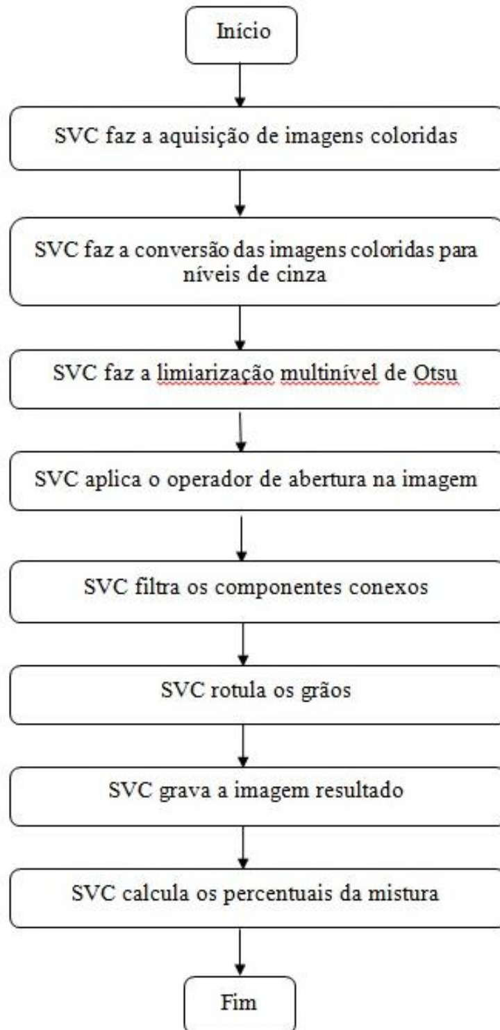
Figura 45 - Fluxograma com as etapas de funcionamento do algoritmo proposto.
