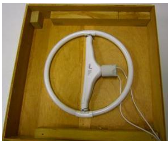
Figura 12 - Lâmpada circular fluorescente no suporte confeccionado.
