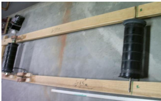
Figura 25 - Base da esteira com os dois rolos de impressora.
