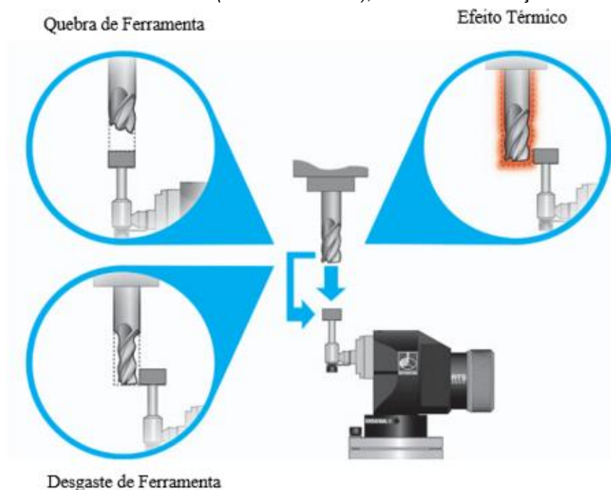
Figura 16 - Presetter de contato (sistema wireless ), executando medição de fresa de topo.
