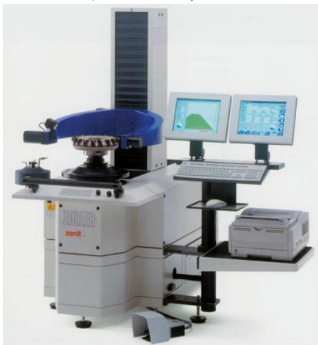
Figura 13 - Presetter com capacidade de medição de ferramenta de perfil definido.
