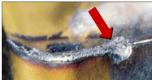
Figura 8- Avarias e desgastes de ferramentas de corte.
