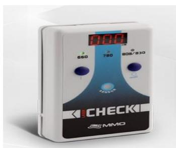
Figura 6. Equipamento para aferir a potencia do laser de baixa intensidade
