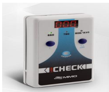
Figura 2. Equipamento utilizado para aferir a potência do laser.
