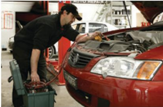
Imagens 10 e 11: Qualquer trabalho envolvendo transferência ou abastecimento de óleos, refrigerantes ou outras substâncias devem ser realizados no interior do edifício ou em área com contenção.
