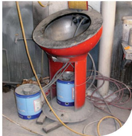
Imagem 7: Uma unidade de recuperação solvente pode cortar custos.
