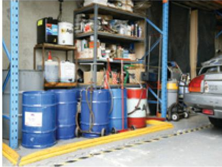
Imagem 13: Assegure que óleo usado esperando pela coleta esteja estocado em uma área protegida bem mantida e com contenção
