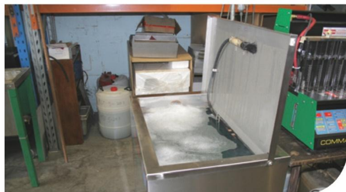
Imagem 8: Considere usar limpeza ultrassônica e elimine uso de solvente
