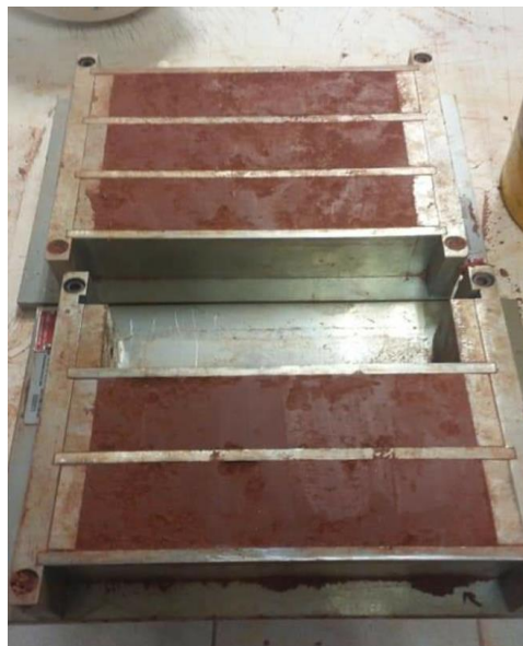
Figura 18. Moldagem dos corpos de prova
