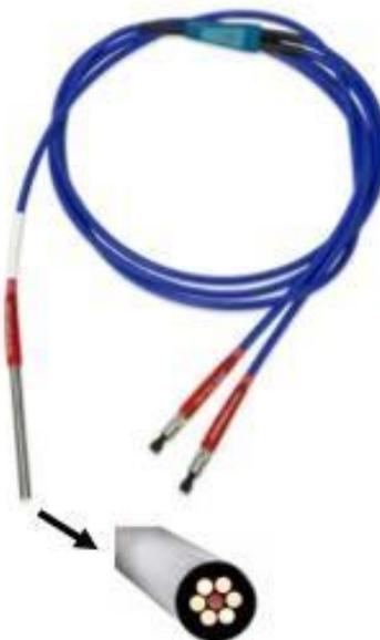
**Figura 14 – Imagem da fibra óptica bifurcada utilizada para a obtenção dos espectros de reflectância. No detalhe, abaixo, a extremidade da ponteira, contendo sete fibras ópticas.**
