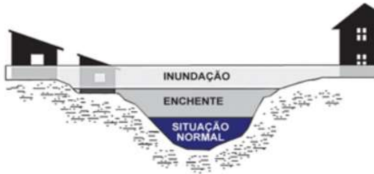
Figura 1 - Perfil esquemático de inundação, enchente e alagamento
