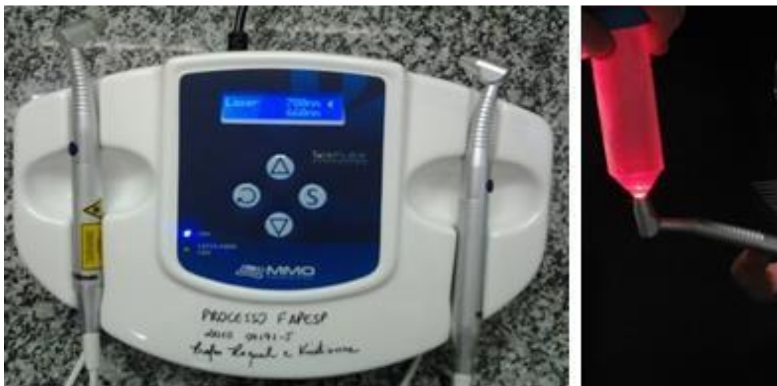
Figura 4: Aparelho Twin-laser (MM Optics, São Carlos – SP - Brasil) sendo utilizado para irradiação das células na parte inferior dos tubos de centrifugação.
