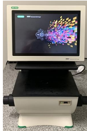
Figura 13: Microscópio de fluorescência ZOETM, BIO-RAD Laboratories. Fonte: autor.
