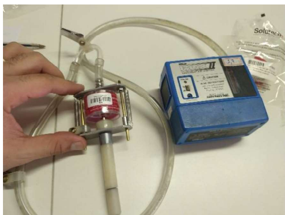
Figura 15 - Bomba e acessório
