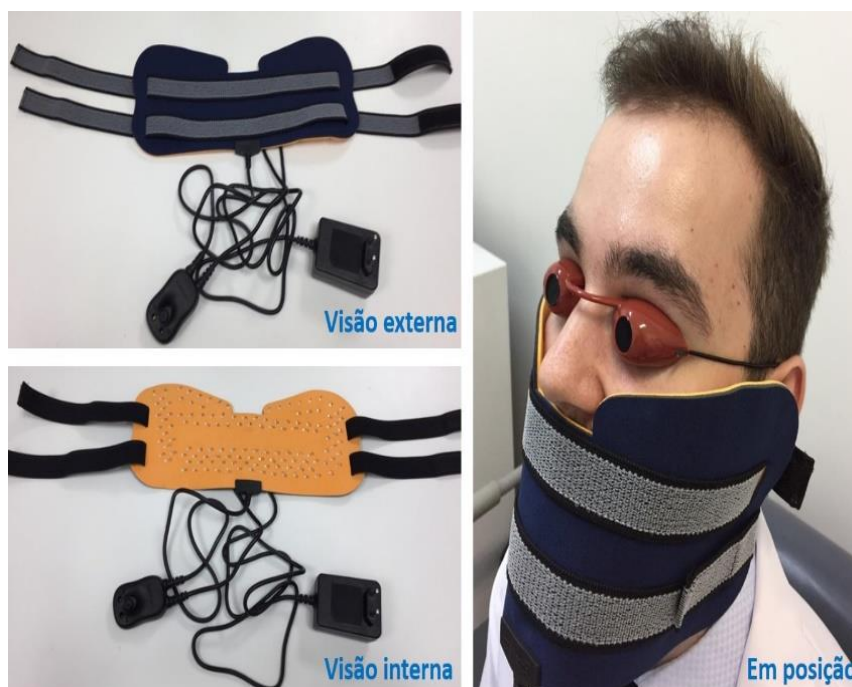
Figura 13. Ilustração da máscara de LED para aplicação extraoral da FBM. Imagem de fonte própria.
