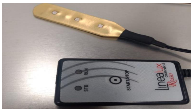
Figura 14. Ilustração do dispositivo de FBM intraoral utilizado no estudo. Imagem de fonte própria.
