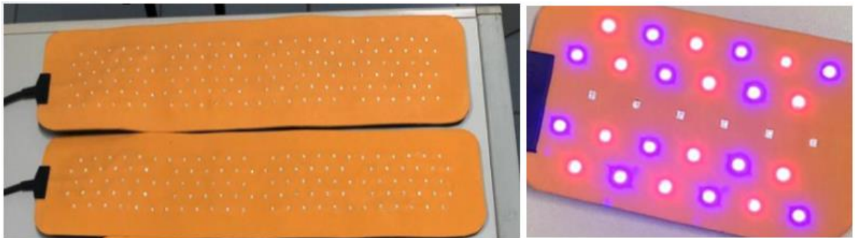
Figura 9 – Dispositivo de TF contendo 144 diodos emissores de luz
