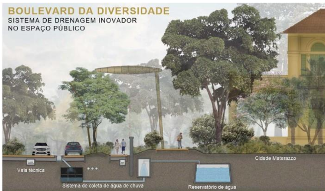
Figura 7. Boulevard da Diversidade: Sistema de Drenagem inovador no Espaço Público.
