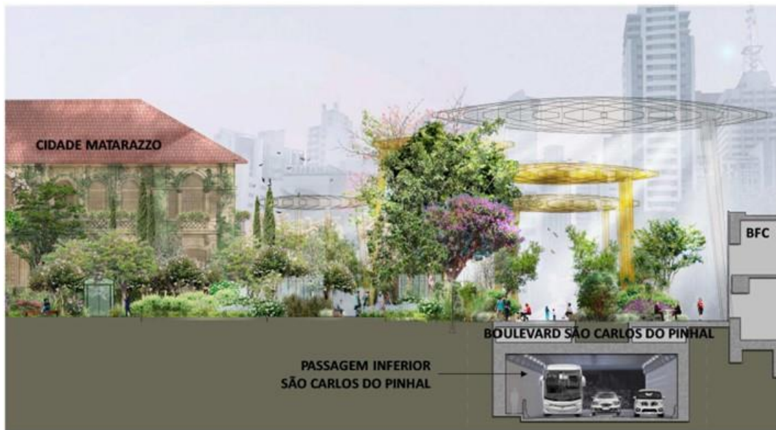
Figura 8. Representação do projeto concluído com a passagem subterrânea de veículos e o Parque das Flores acima dele.
