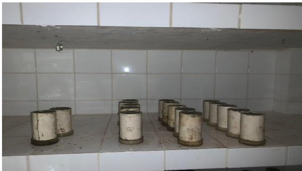
Figura 9. Armazenamento corpos de prova em câmara úmida.
