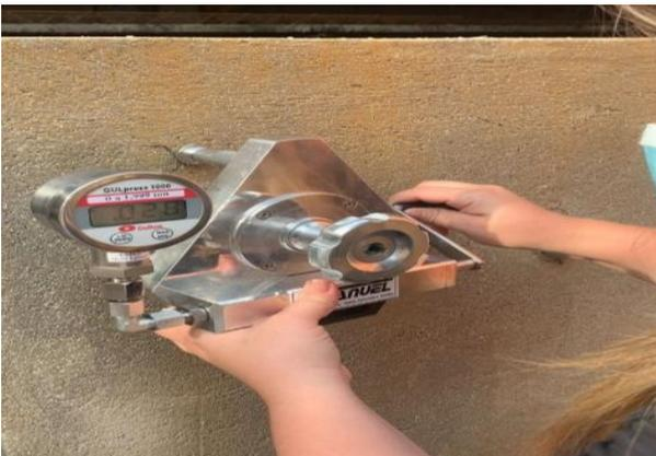
Figura 29. Ensaio de arrancamento (teste de aderência a tração).
