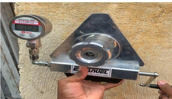
Figura 30. Ensaio de arrancamento (teste de aderência a tração).
