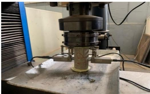
Figura 14. Ensaio a compressão com módulo de elasticidade (com extensômetro).
