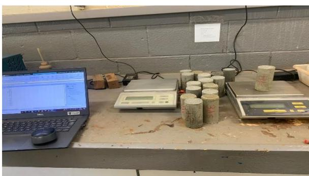
Figura 11. Pesagem e medidas corpos de prova desmoldados.
