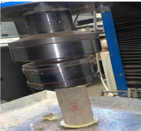
Figura 13. Momento da ruptura do corpo de prova.
