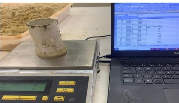
Figura 8. Pesagem corpo de prova.
