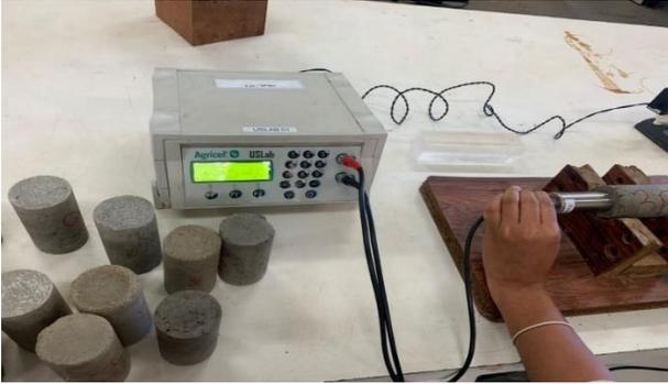
Figura 12. Ensaio de ultrassom após desmoldagem.
