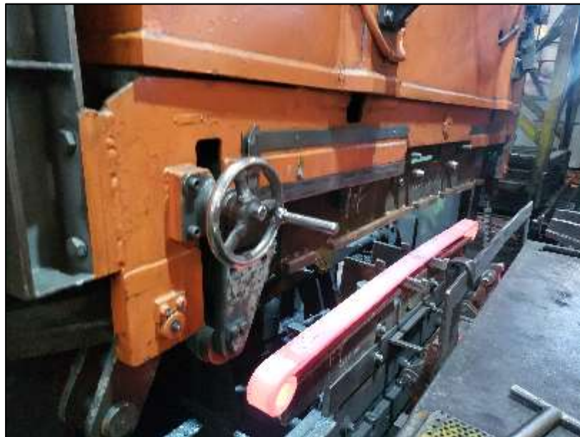
Figura 29- Mola arqueada e mergulhada em óleo
