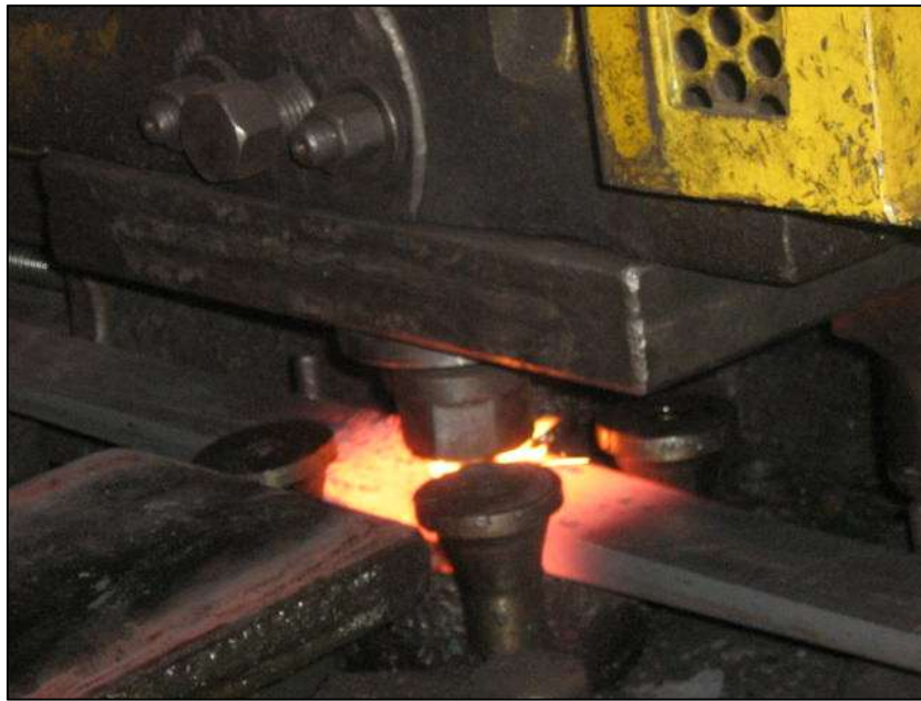
Figura 28-Operação de furar centro a quente na ferramenta auto-centrante
