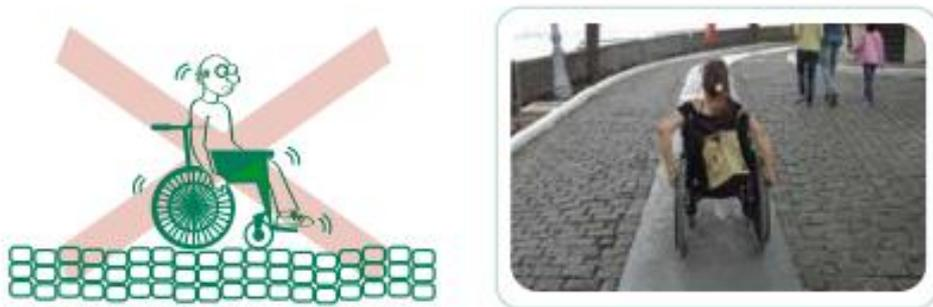
**Figura 3-**Imagem de exemplo de superfície da Faixa Livre.
