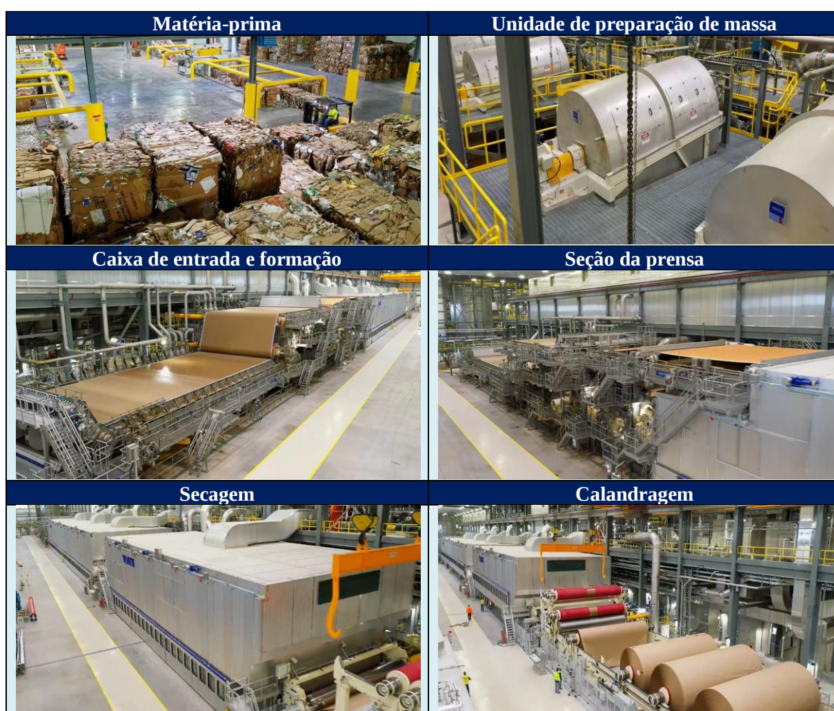
Figura 4: Principais partes da máquina para produção de papel embalagem.
