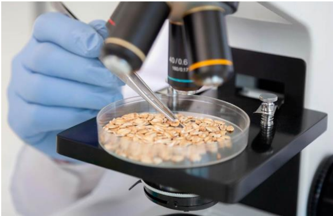
Figura 1 – Inspeção visual manual
