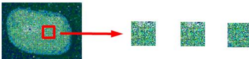
Figura 16 - Amostras de treinamento (ampliadas) de 50 × 50 pixels sem defeito (normal)
