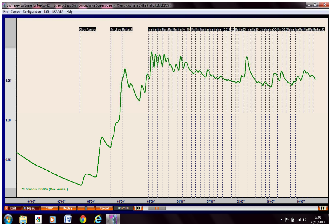
Figura 11: Interface gráfica para identificação dos picos de onda SCR
