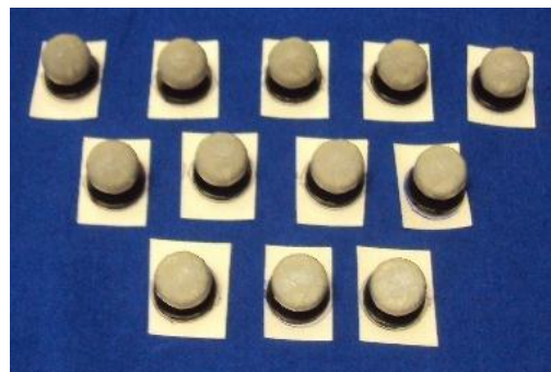
Figura 2: marcadores passivos retro-reflexivos usados para coleta
