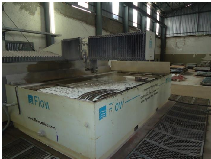
Figura 16 – Equipamento Flow para corte com jato d’água
