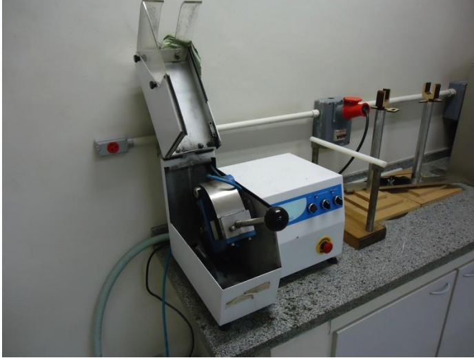
(a) Serra policorte com refrigeração forçada Fonte: Laboratório UNINOVE – campus Santo Amaro
