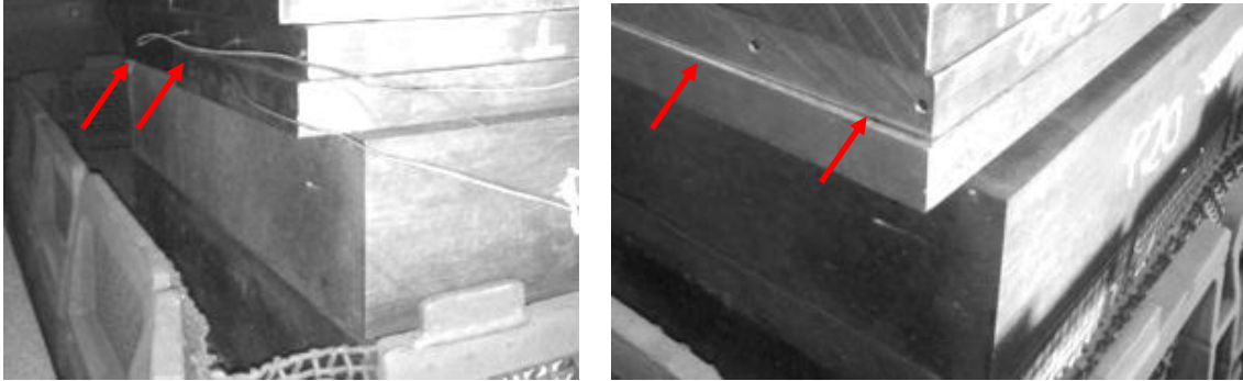
Figura 14 – Posicionamento dos termopares na ferramenta industrial
