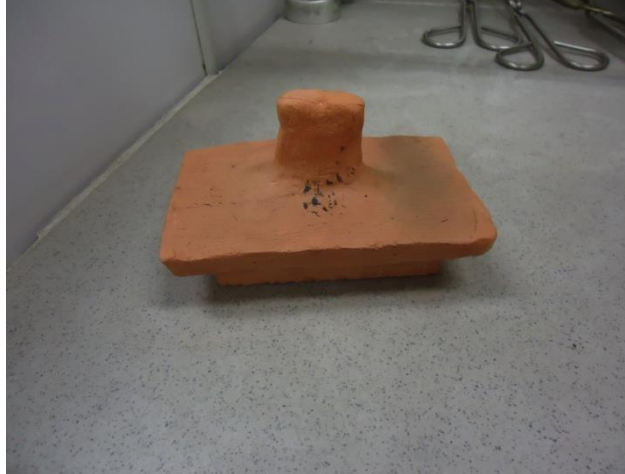
Figura h – Porta de cerâmica refratária com abertura para inserção de termopar
