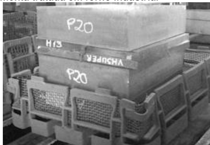
Figura 13 – Ferramenta tratada em forno industrial
