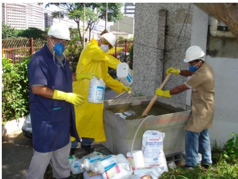
Figura 10: Processo de Inativação do Glutaraldeído para descarte na rede pública
