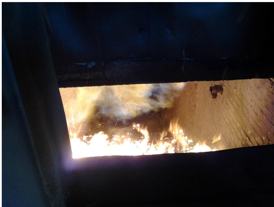
Figura 12: Biogás queimando na fornalha para geração de calor e secagem da mandioca moída. Fonte: Arquivo pessoal do autor.
