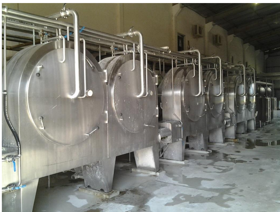
Figura 10: Peneiras rotativas GLS utilizadas para separar o amido da fibra de mandioca. Fonte: Arquivo pessoal do autor.
