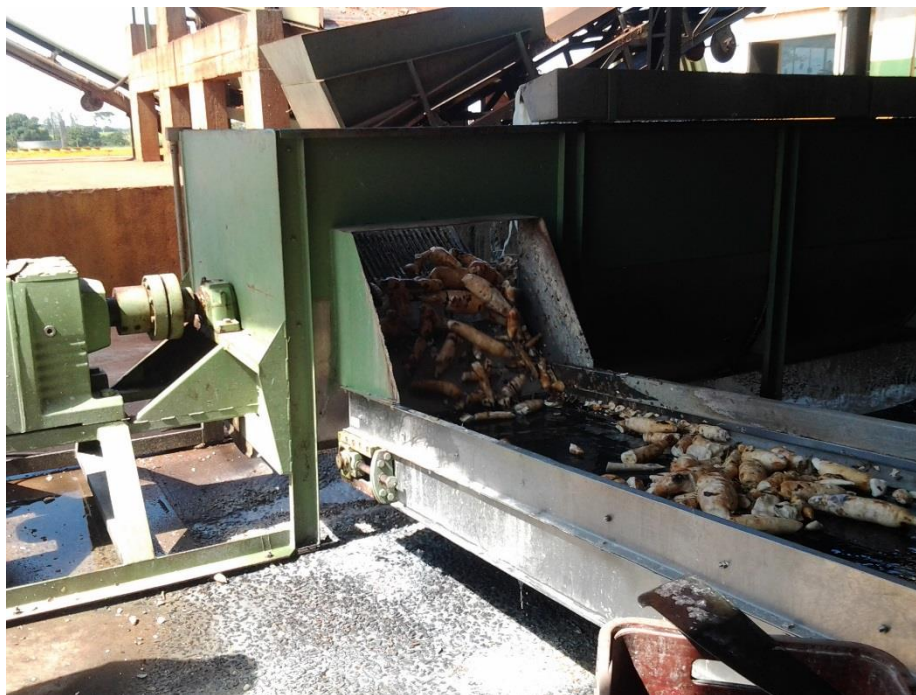
Figura 9: Etapa de descascamento e lavagem simultâneas da mandioca. Fonte: Arquivo pessoal do autor.
