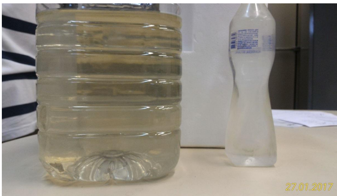
Figura 15 - Efluente da ETE e permeado obtido da filtração por membranas
