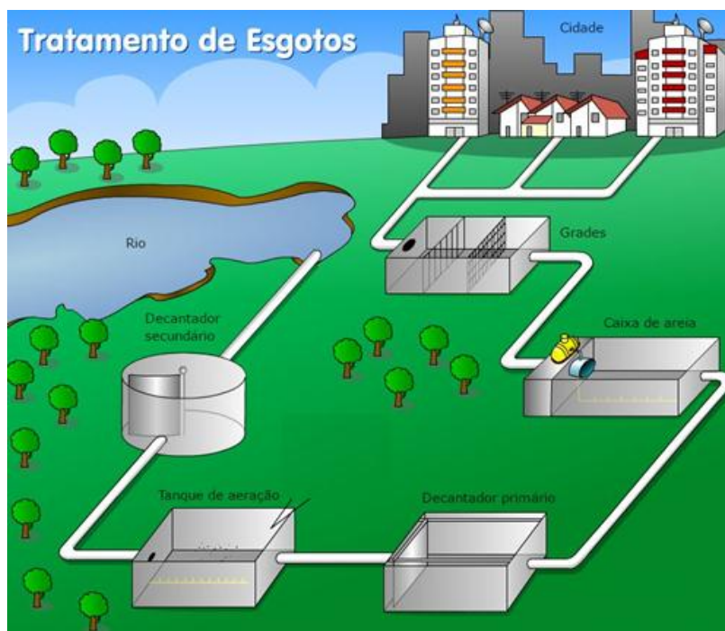
Figura 6 - Tratamento de esgoto fase líquida
