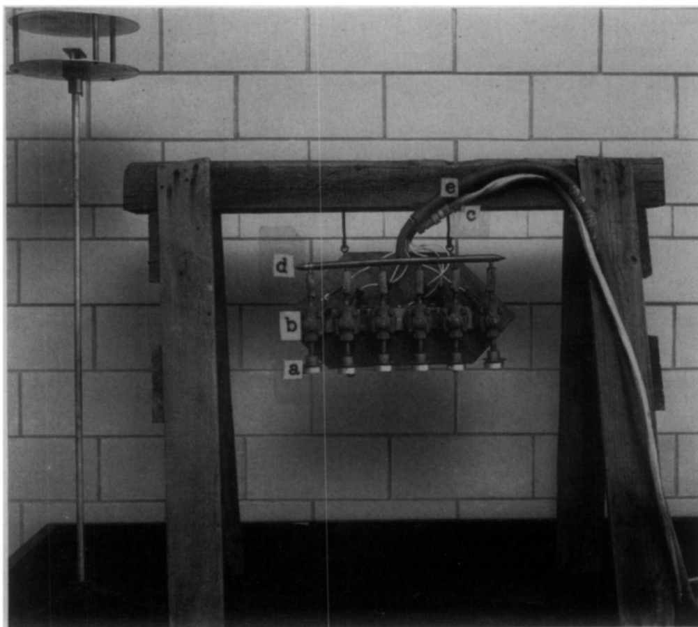
Figura 9 - Parte do aparelho que contém os filtros moleculares de membrana e um amostrador de gravidade convencional.
