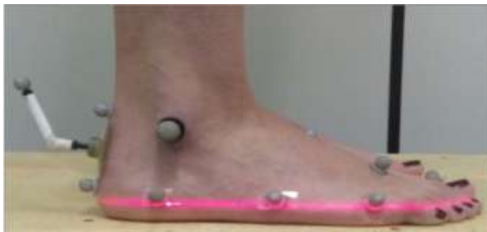
Figura 6. Utilização do laser para alinhamento dos marcadores.
