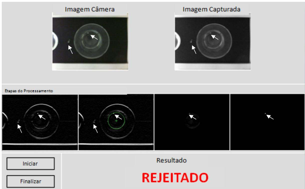
Figura 27: Exemplo de partículas de vidro com baixo contraste detectado com sucesso.
