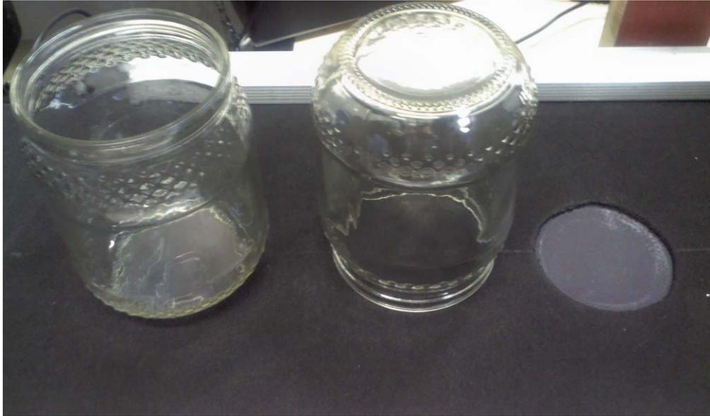
Figura 15: Gabarito criado para evitar deslocamento do pote a ser inspecionado.
