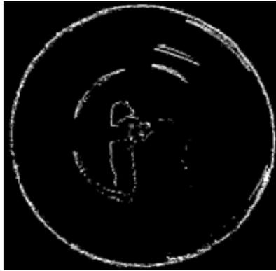
(a) Saída do processo de detecção de bordas
