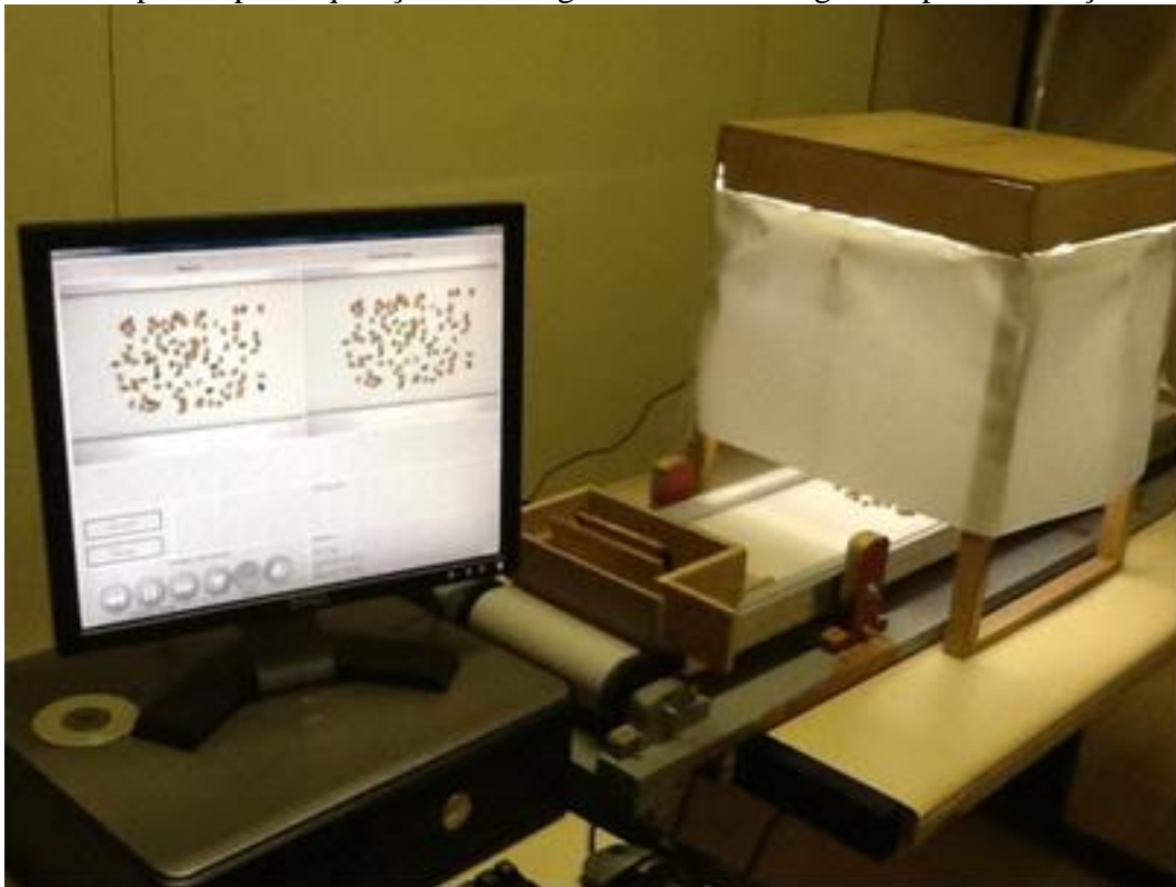
Figura 10: Aparato para aquisição das imagens e a interface gráfica para utilização do SE.
