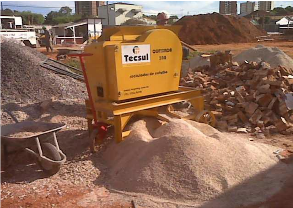
Figura 45. Equipamento para reciclagem de resíduos de alvenaria e concreto denominado Queixada 300.
