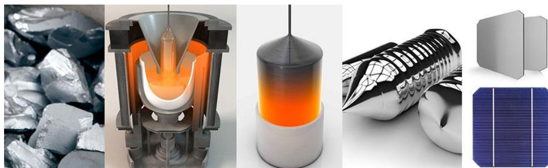
Figura 22 – Processo de fabricação de uma célula fotovoltaica, da esquerda para direita, minério de silício puro, forno Czochralski, lingote de silício, fatias ( wafers ) e a célula fotovoltaica monocristalina.
