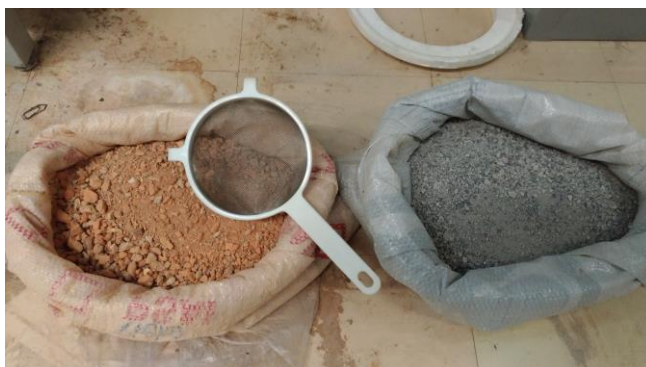
Figura 36 – Agregados de resíduos da construção civil (RCC), identificado respectivamente na esquerda como RCC cerâmica e direita RCC alvenaria.
