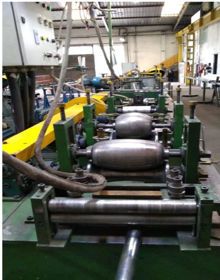
Figura 7 - Perfiladora de tubos e aço
