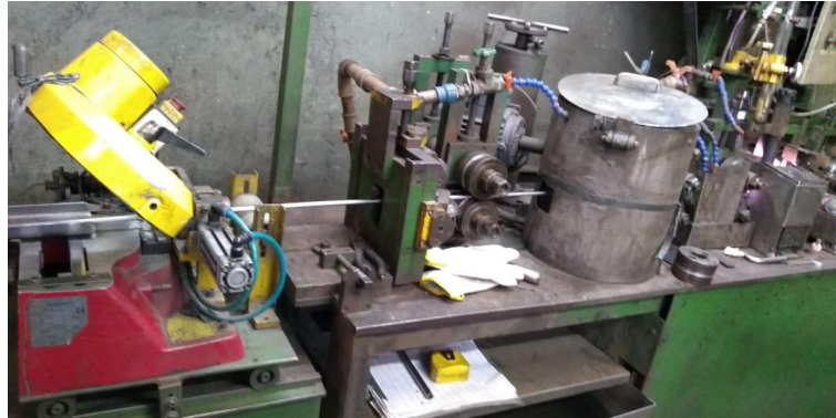
Figura 8 - Processo de lixamento em Perfiladora de tubos de aço
