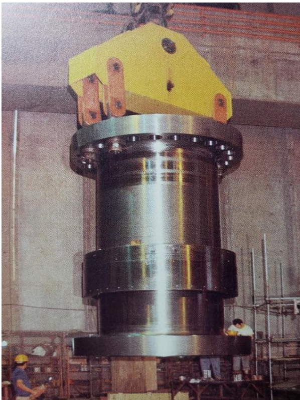
Figura 30 – Eixo da Turbina
