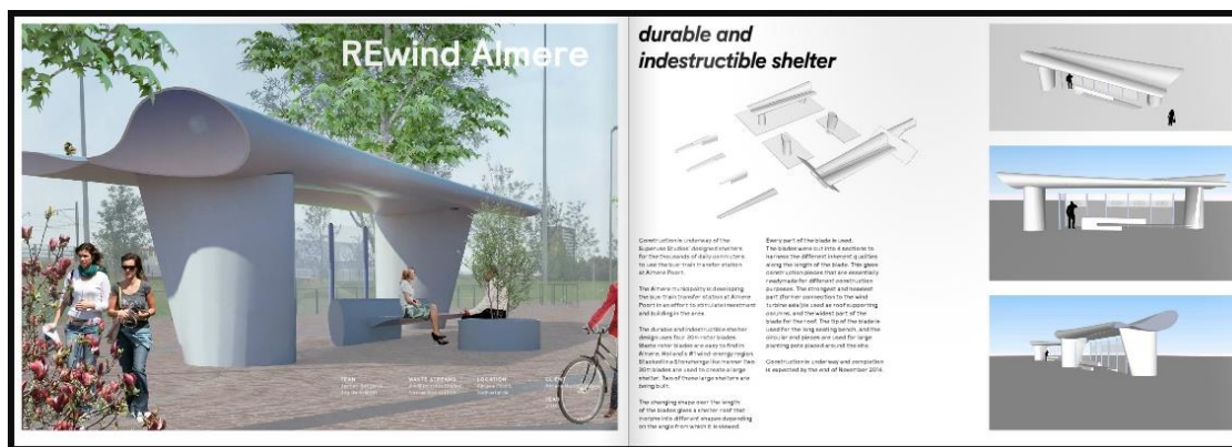
Figura 4 – Projeto de ponto de ônibus feito com pás de turbinas eólicas.
