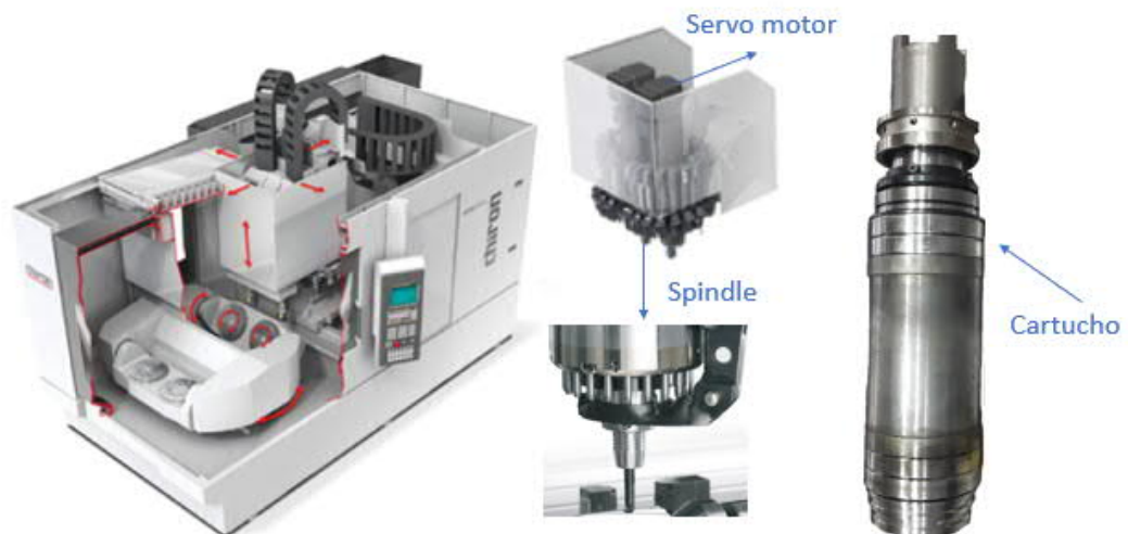
Figura 18 - Posicionamento do spindle e Servo motor
