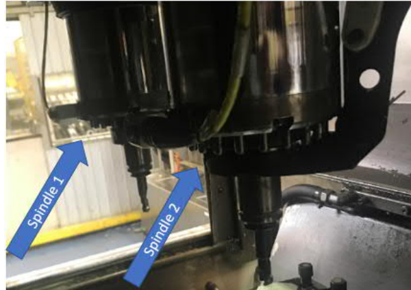
Figura 26 - Spindles com Sensores Posicionados
