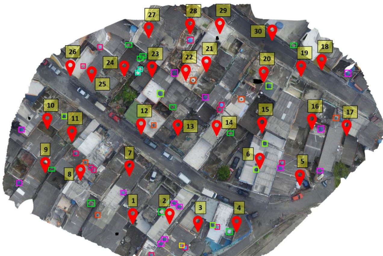
Figura 63: Ortomosaico_Guaianases_1 com as detecções dos objetos-alvo e as demarcações de acordo com as coordenadas georreferenciadas
