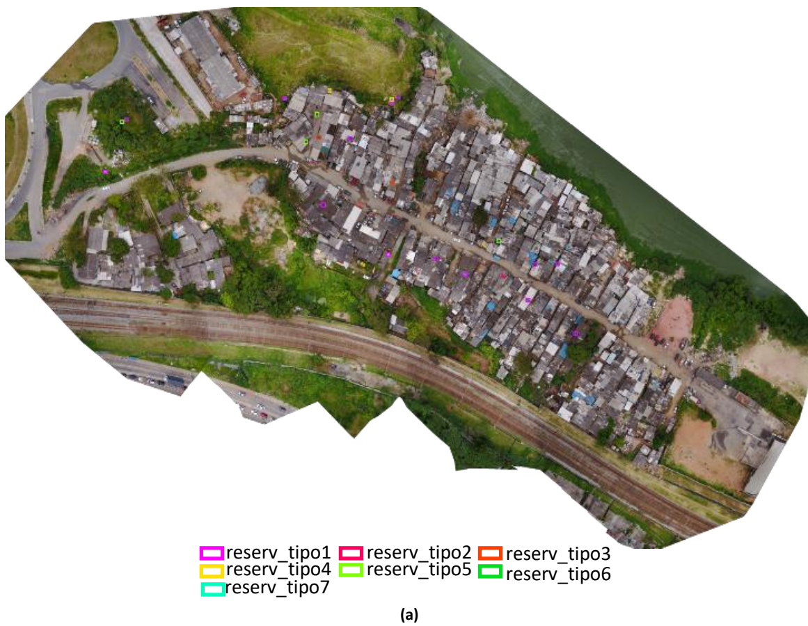
Figura 55: Resultados das detecções dos reservatórios d'água no Ortomosaico_PortoAreia: (a) ortomosaico completo; (b) subimagem do ortomosaico com os objetos-alvo detectados
